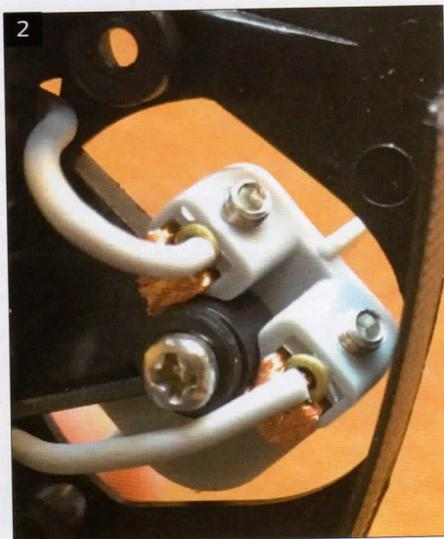
Además de cambiar los cables por otros más finos y flexibles su colocación y soldadura en el motor se debe realizar de manera que moleste lo menos posible. Mi solución ha sido la que se ve en la foto 3. Vuelvo a repetir, mucho cuidado al atornillar los allen encargado de sujetar los terminales pues si apretamos demasiado pasaremos la rosca e inutilizaremos la guía. Hablo por experiencia naturalmente.
