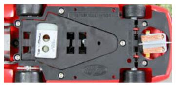
Sidewinder oder Anglewinder? Beides! Dazu eine komplett verschraubte Mechanik. Vorderachse in der Höhe einstellbar. Sílikonreifen mit viel Grip. Verschraubter Leitkiel mit raffiniert geschwungenem Schwert. Der Antriebsstrang ist über fünf Schrauben vom Hauptchassis entkoppelbar. Die Karosserie wird über drei Schrauben fixiert: vorne zwei, hinten eine. Leider braucht man einen kleinen Torx Dreher. Die Sternschrauben halten länger, aber wer das Werkzeug nicht hat, sofort kaufen!
