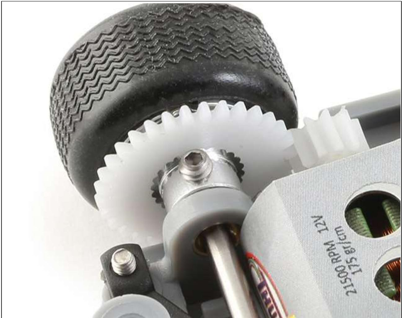
Le viti a brugola previste per corona, cerchi posteriori, regolazione laterale carrozzeria, regolazione assetto anteriore e pick-up sono di tipo M3.
