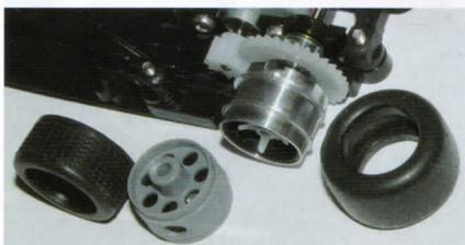
miert. Hinten sind sie mit Stegen für die Reifen und auch vorn mit Bohrungen im Felgenbett versehen. Die Vorderachse wird in Langlöchern im Fahrwerk geführt und ist über die vorhandenen Inbusschrauben in der Höhe einstellbar. Optional kommt auch die Lagerung an den beiden innen liegenden Haltern in Betracht (vgl. I.).
