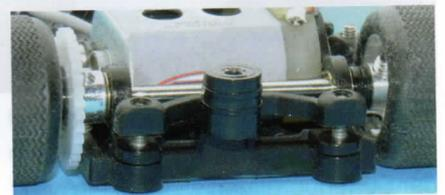
einer verschraubten Quervertraverse bestückt. Es wird ohne Haftmagnet geliefert, doch kann man bis zu zwei vor dem Motor einfügen. Seitlich sind an dem Fahrwerk außerdem Stützen vorhanden, an denen die Einbauhöhe der Karosserie etwa bei Montage größerer Räder variiert werden kann (vgl. I.).
