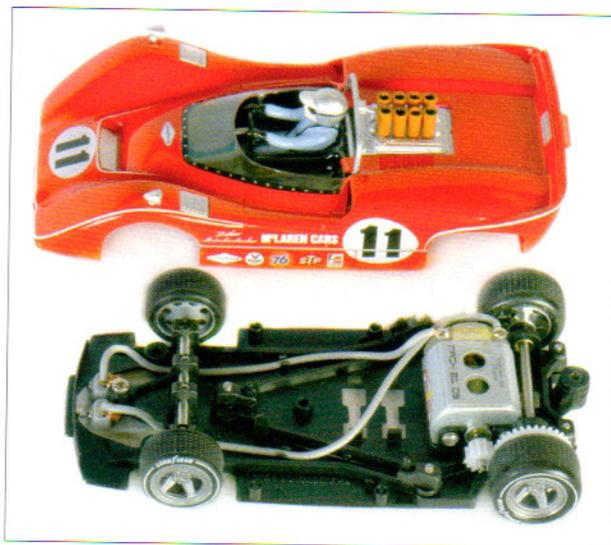
En nuestro caso, el chasis y soporte motor de color negro de dureza media suficiente para aguantar las embestidas de un motor tipo cacahuete que si sitúa en posición "pseudo-sidewinder", ya que no es completamente paralela al eje trasero. Esto tiene sus ventajas, pues se puede montar la corona de serie de tan sólo 17,2 mm de nylon y 32 dientes que, por cierto, está muy bien alineada, atacada correctamente por un piñón de 11 dientes, también fabricado en nylon.
